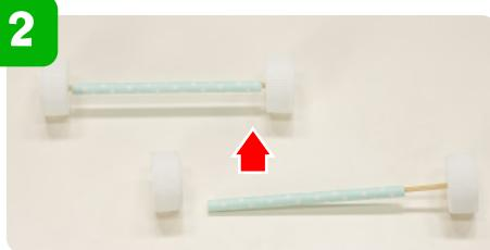
竹串を12.5cm、ストローを10cmにそれぞれカット。穴をあけたペットボトルのフタにまず竹串を刺して、その上からストローを通して、その反対側にもフタを刺して、車輪を作ろう。
